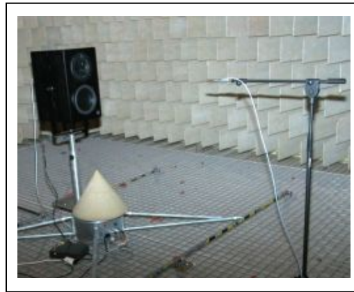
Abb. 3: Messaufbau im reflexionsarmen Raum
