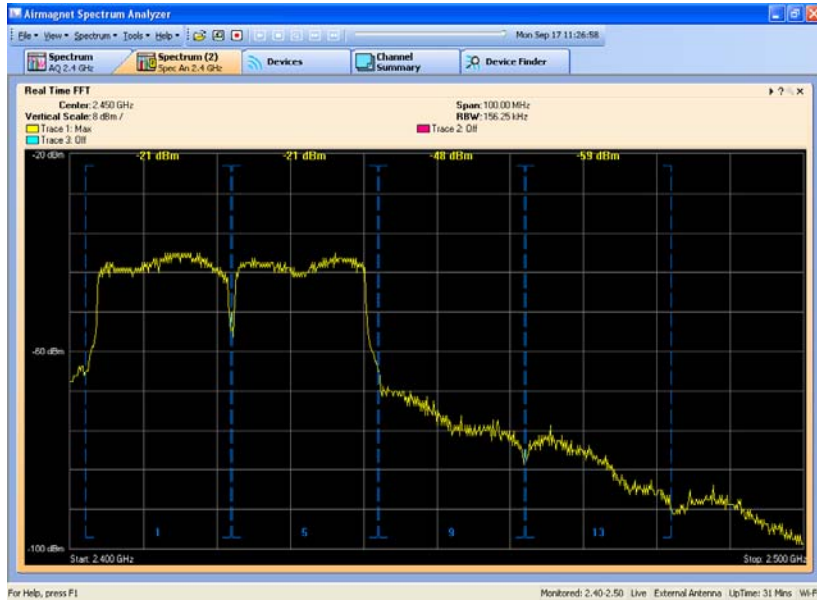
Abbildung 10: Spektrum eines 40MHz WLAN-Kanals.
